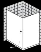
Der versetzte Drehpunkt sorgt für einen geringen Schwenkbereich der einteiligen Flügeltür.
