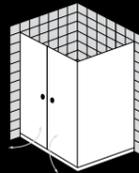
Einteilige Flügeltür mit versetztem Drehpunkt und Seitenwand.
